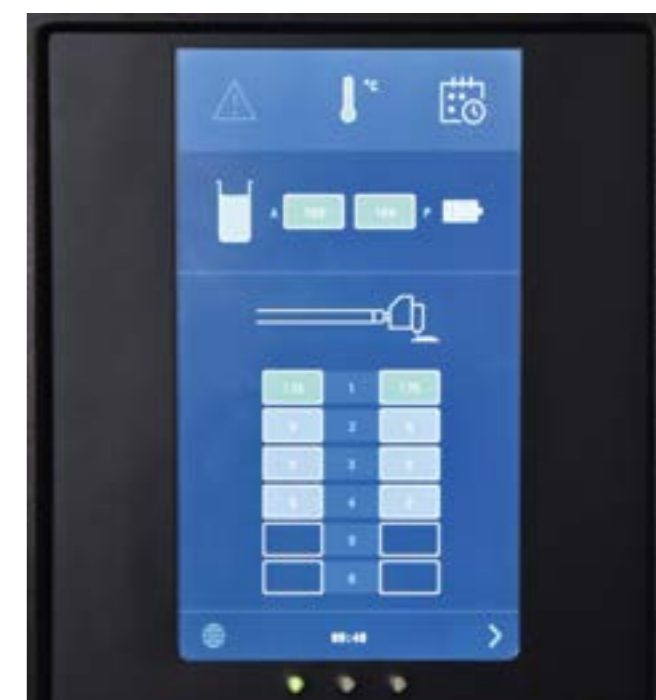
Łatwy do zaprogramowania interfejs użytkownika z 7-calowym ekranem dotykowym
