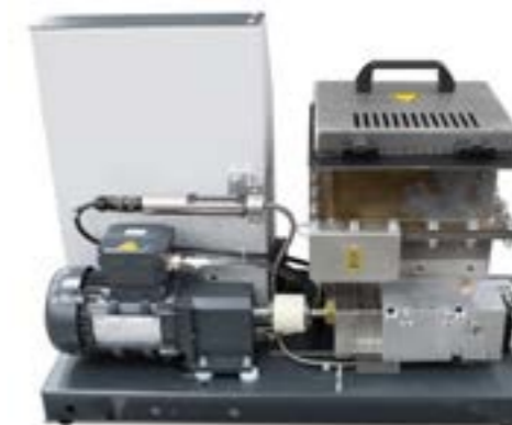
Konstrukcja przyjazna podczas konserwacji z dobrym dostępem do wszystkich komponentów.
